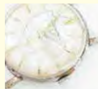
時計のガラスが割れている。
